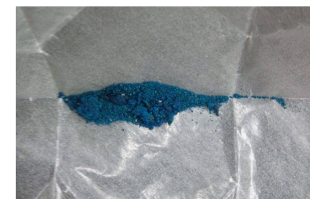
Photo. 4 合成試料の外観 上: \text{Na}_3\text{MnO}_4 下: \text{Ba}_5(\text{P}_{1-x}\text{Mn}_x\text{O}_4)_3\text{F}
